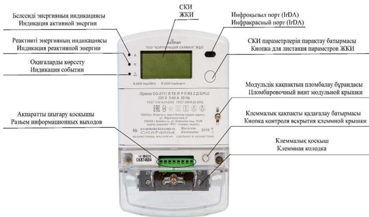
2-сурет – «ОРМАН» СО-E711 есептеуішінің сыртқы бөлшектік элементтерінің сипаттамасы
